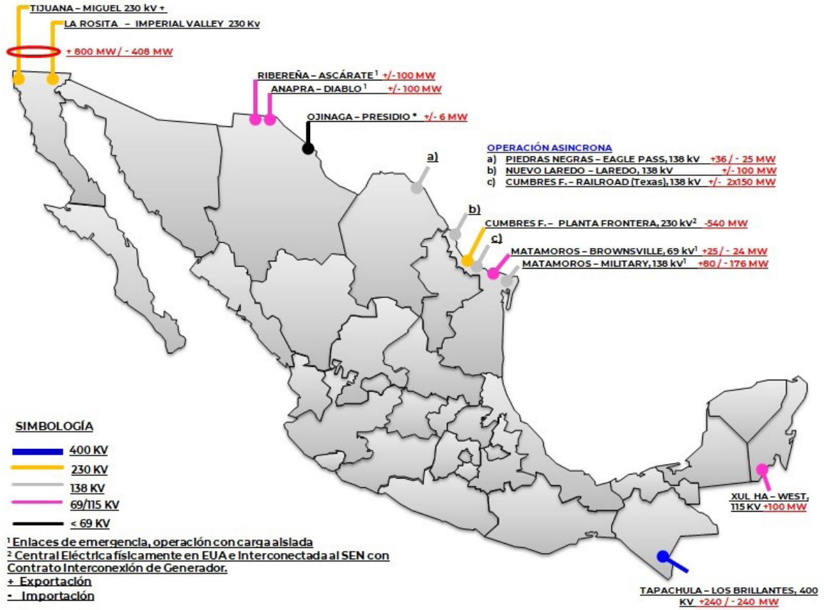
FIGURA 5.11 CAPACIDAD DE LAS INTERCONEXIONES INTERNACIONALES 2018
